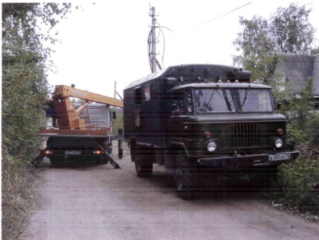
Фургон кабельный на базе ГАЗ-66, АП-17 (автоподъемник)
