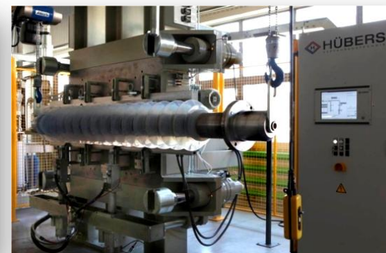
Пресс-форма для комплекса HUBERS по производству полимерных изоляторов
