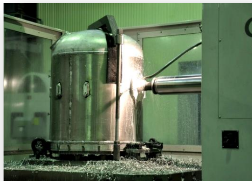
Фрезерный станок с ЧПУ обеспечивает высокую точность обработки деталей
