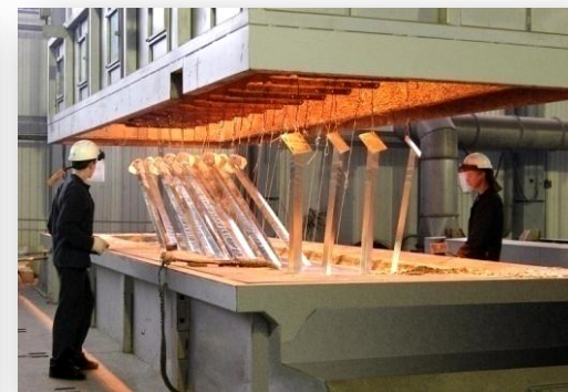
Детали подверженные воздействию неблагоприятных внешних факторов проходят процесс горячего цинкования на оборудовании фирмы HASCO (Великобритания)
