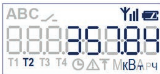
Рисунок 3. Пример отображения показаний электроэнергии на ЖКИ
