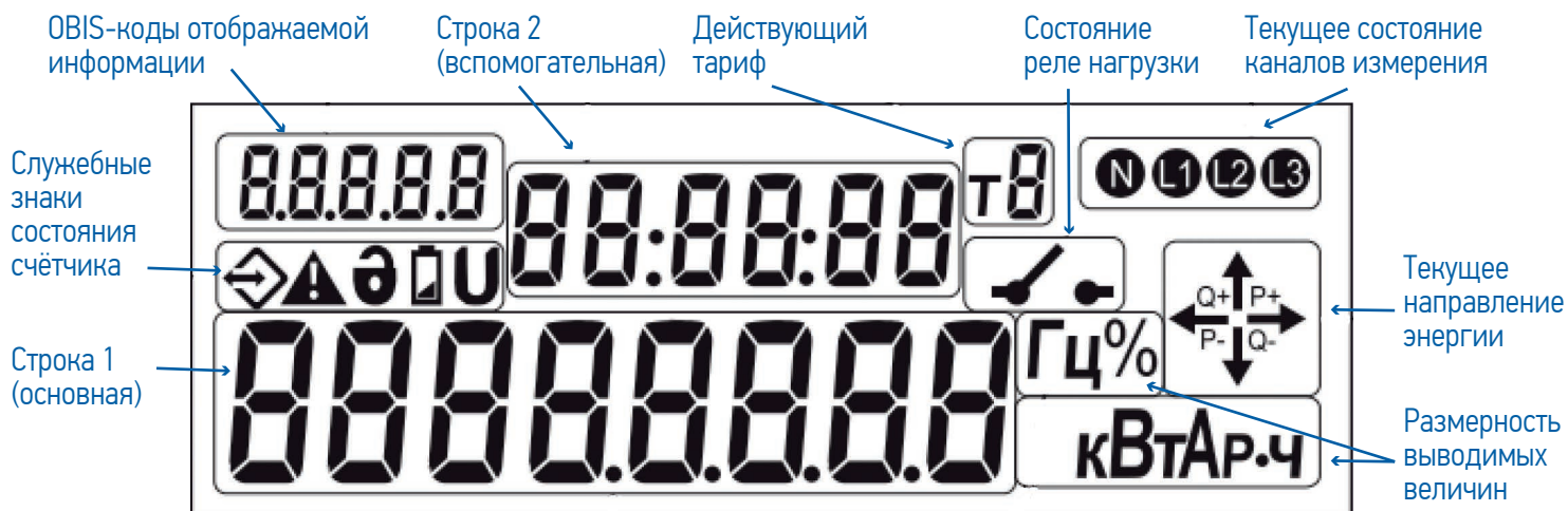
Рисунок 2. Вид ЖКИ Пульта СЕ и назначение отображаемых символов
