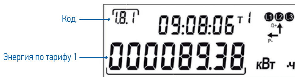
Рисунок 4. Пример отображения на экране Пульты СЕ потребленной по тарифу 1 (Т1) электроэнергии
